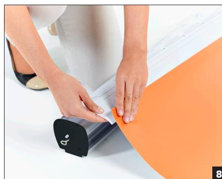
Beginnen Sie an einer Seite, den neuen Druck mit dem Klebestreifen auf der Transferfolie zu befestigen. Schieben Sie dann den neuen Druck am oberen Ende in die Klemmschiene. Richten Sie das System auf und entfernen Sie den Splint, so dass der Druck wieder eingefahren werden kann.
